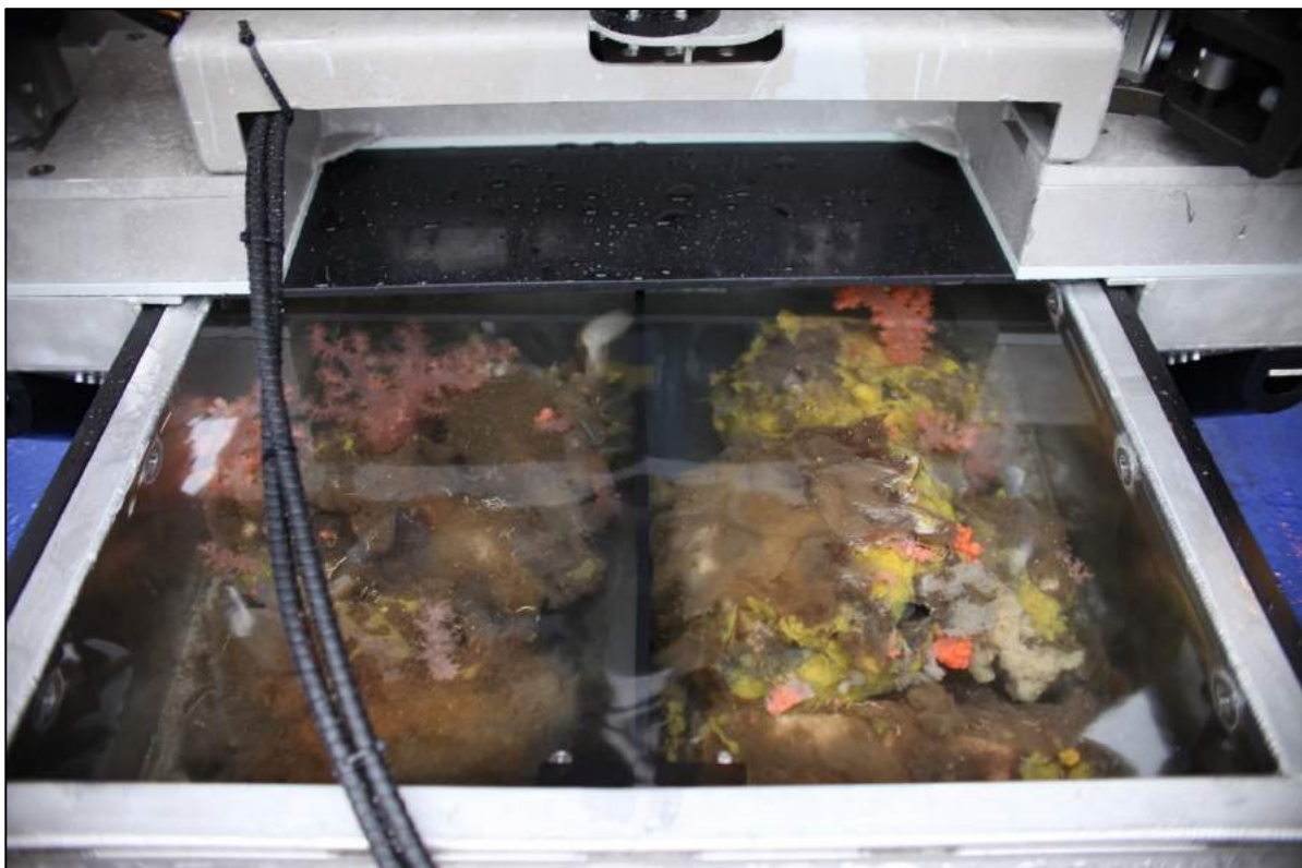
Figur 3. Skuffe til skånsom oppbevaring av prøver tatt med robotarm til ROV. Skuffen beholder vannet slik at organismene ikke blir ødelagt og kan transporteres til laboratoriet om bord for videre undersøkelser.
