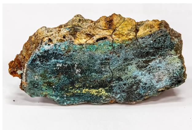
Figur 5.3 Sulfidprøve fra Mohnsryggen Det grønne mineral er Atakamitt, som er rikt på kobber
