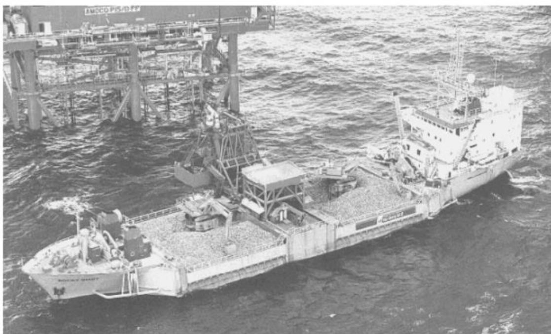
> Figur 10-17: Eksempel på steindumpingsfartøy med fallrør (fall-pipe) [81]
