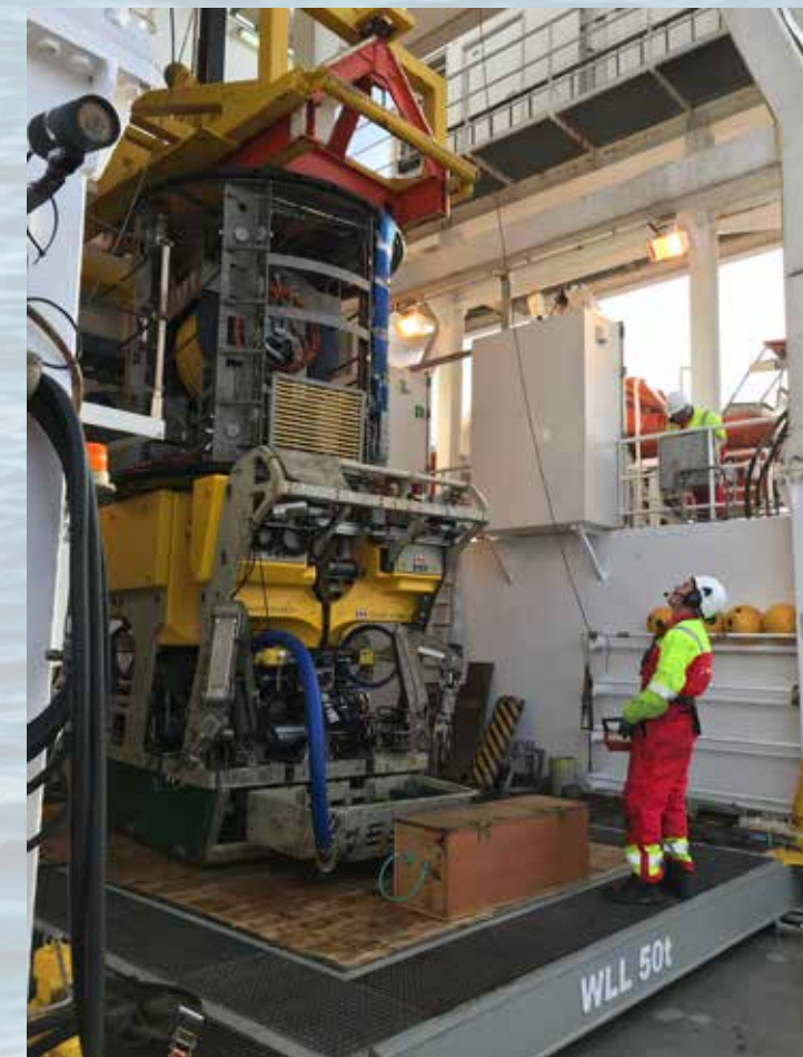
ROV For kartlegging og prøvetaking benyttes blant annet ROV, som er en fjernstyrt undervannsfarkost (Remotely operated vehicle). (Foto: K. G. Jebsen-senter for dyphavsforskning ved Universitetet i Bergen)
