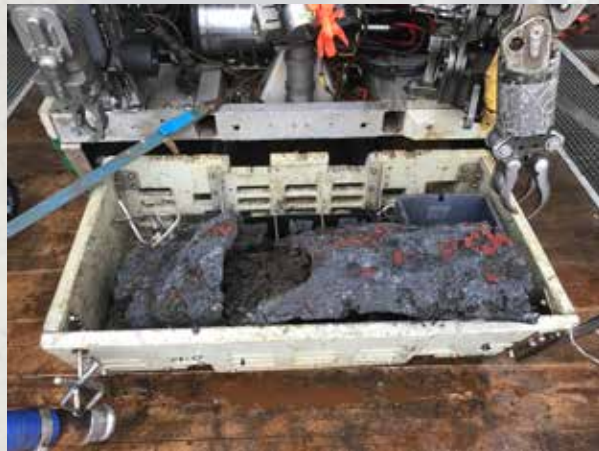
Skorstein Oljedirektoratet hentet i 2018 en eldre utslukket svart skorstein fra 3000 meters vanddyb ved Fåvne-feltet i Norskehavet. (Foto: K. G. Jepsen-senter for dyphavsforskning ved Universitetet i Bergen)
